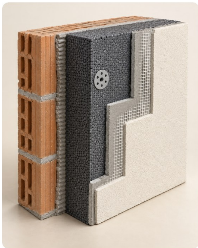
Ilustrační řez zateplením s grafitovým EPS.
